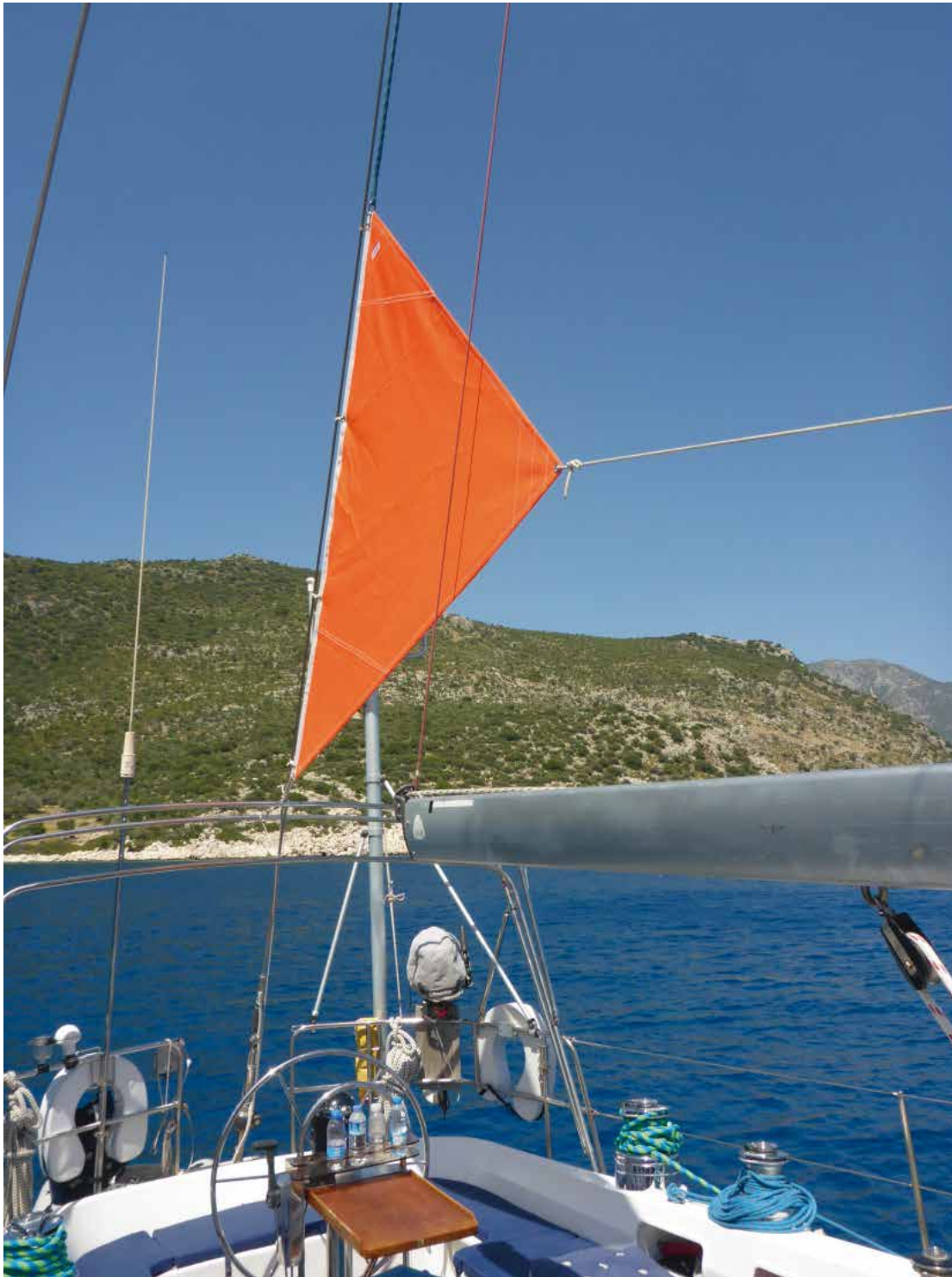
Min båt Saritas ankarsegel hissad på akterstaget och skotat framåt. Vinkeln och höjden är anpassad för att kunna ha uppe soltältet samtidigt. Det ser litet ut men gör skillnad i en byig vind och minskar seglandet avsevärt. Här ligger vi i Kalkan i Turkiet 2014, ett ställe som är känt för fallvindar. Innan bilden togs kom ett par stormbyar som slet sönder både Biminitopp och soltält under ankringsmanövern.
